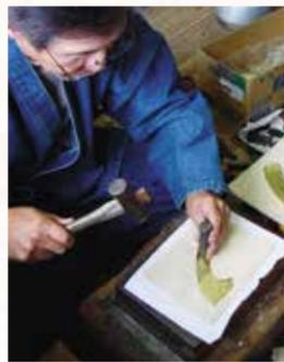
表面を数回打ち込み、反りが出たところを裏面にして反りを調整しながら木槌で伸ばし打ちしていきます。
